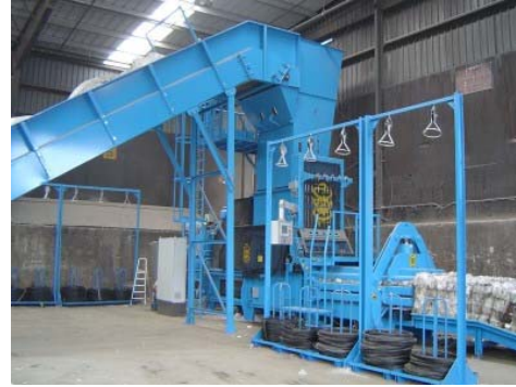
Figuur 5.3: Grote pers voor papier, karton en plastic (BOA, Enschede)
