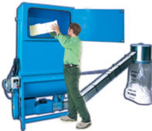
Figuur 5.4: compacte pers van TRECO-star, perst piepschuim tot 40 maal zo klein!
